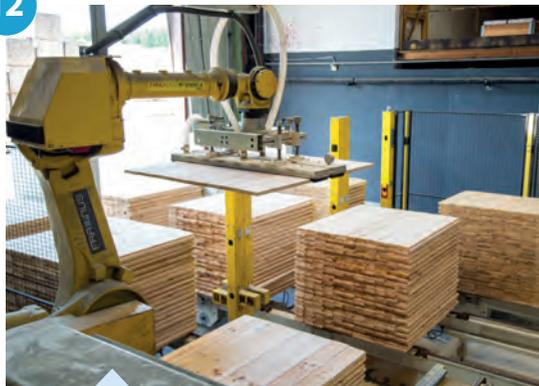
Dépilage automatique des planches par un robot et composition du plateau supérieur de la palette.
