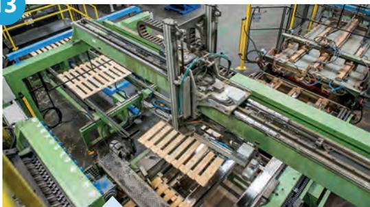
Assemblage du plateau supérieur de la palette (planches et traverses) et convoyage vers le poste de clouage automatisé pour le positionnement des dés.
