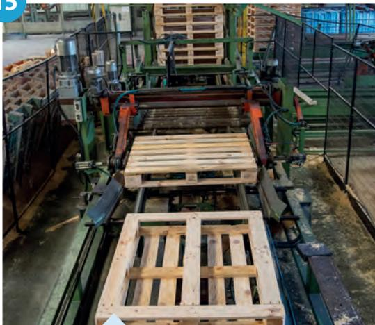
Sortie du dernier poste de clouage des semelles de la palette et orientation vers les postes d'usinage (coupes d'angles, chanfreins) et de marquage.
