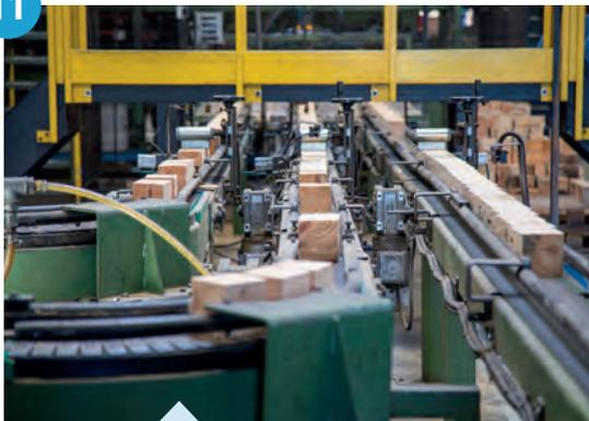
Tronçonnage des chevrons en dés à palettes aux dimensions requises pour les fabrications et convoyage vers les différents postes de clouage.
