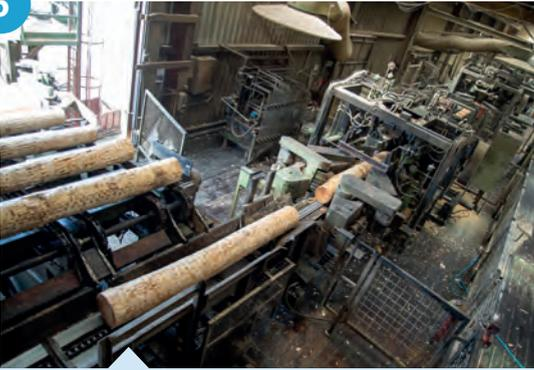
Premier débit : selon conformité et diamètre des billons (généralement diamètre de 10 à 40 cm fin bout pour les résineux), l'épaisseur et la largeur des planches ou chevrons sont programmées pour l'obtention d'un rendement matière sous écorce optimal.
