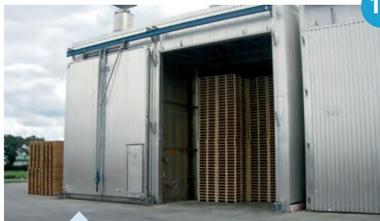
Séchoir pour prestation NIMP15 et/ou séchage artificiel des palettes.
