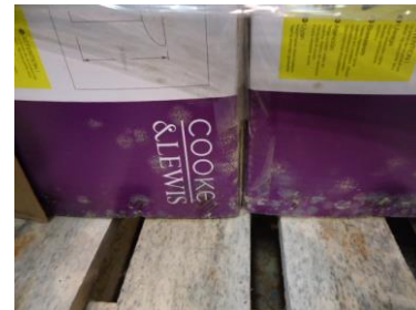
Photo 3: développement de moisissures dans un container maritime
